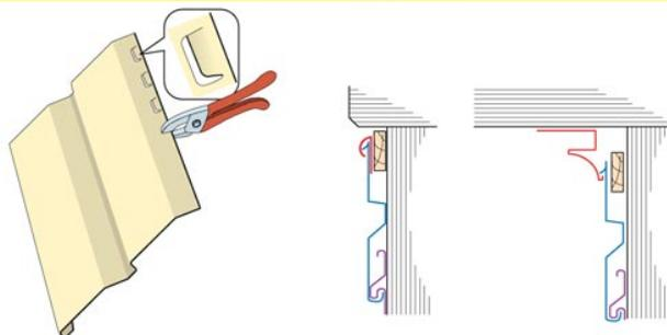
Финишный профиль и молдинг устанавливают на стене непосредственно под карнизом крыши или софитом.
