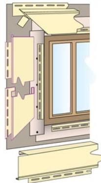
Наличник 89 мм Дёке. Перед установкой наличника по всему периметру окна устанавливаются отрезки стартового профиля. Заготавливаем наличники на оконный проем, длина всех элементов должна быть равной, соответственно, длине и высоте проема плюс две высоты используемых наличников. У верхнего наличника в J-составляющей с обеих сторон делаются надрезы длиной 20 мм, и эти «язычки» отгибаются вниз, по ним вода с верхнего наличника будет отводиться в боковые.
