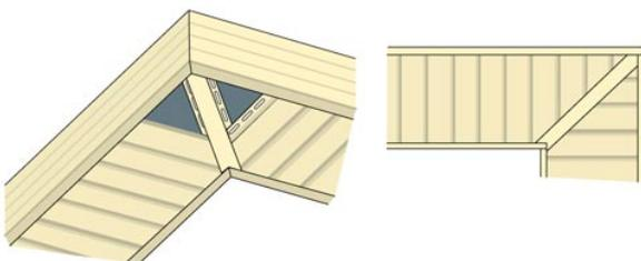
Софмит устанавливается между молдингом и J-фаской. Технология монтажа софмита очень проста: отрезается панель нужного размера за вычетом зазора на установку. Один конец заводится в молдинг, другой в J-фаску. Следующий софмит монтируется таким же образом и защелкивается в замок первого, и так далее.
