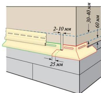
Установку отлива начинают с угла дома. Сначала изготавливается угловой элемент (как показано на рисунке), который крепится на углах дома. Последующие отливы устанавливаются с нахлестом рабочей поверхности = 25 мм. Стартовый профиль монтируется на 30-40 мм выше гвоздевой планки отлива.
