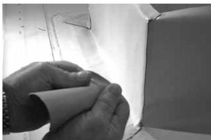
**Рисунок 1.14.** Растягивают нагретый участок вручную.
