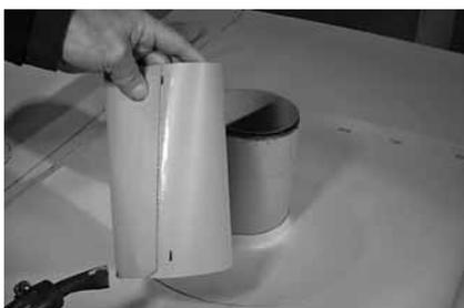
**Рисунок 3.7.** Торец мембраны сваренной трубки разогревают горячим воздухом.
