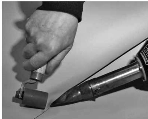
**Рисунок 13.** Ручное сварочное оборудование
